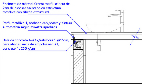
Detalle 01 Estructura de barra M-B Muro bajo
