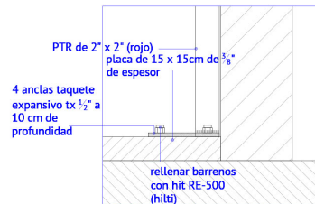
D04 Detalle panel acústico Panel acústico auditorio
