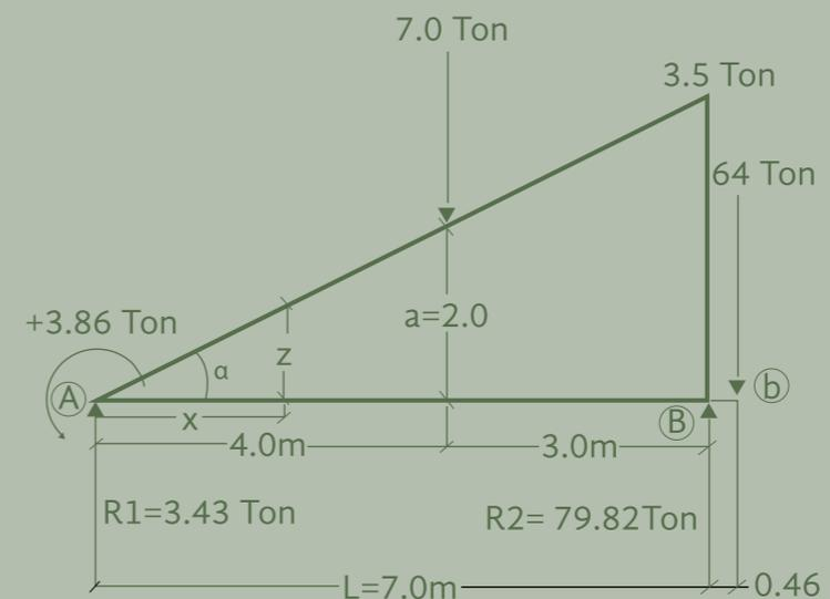
Definamos la altura del triángulo bajo la carga concentrada por la relación de triángulos semejantes:
