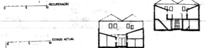
Fig. 22 (izquierda). Croquis del arquitecto A. Siza (brigada técnica de la operación S.A.A.L. "São Vitor"), donde se hace un nuevo planteamiento, utilizando los muros de piedra existentes, a medio demoler por la municipalidad.
